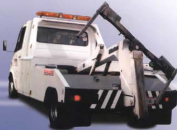
Grúas de arrastre con under lift
