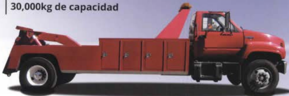
Grúa de arrastre con Under Lift de 15,000kg hasta 30,000kg de capacidad
